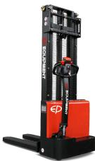
Der ESL122 ist für leichte Stapelvorgänge im Einzelhandel, in Lagern und Verteilzentren konzipiert. Sein kompaktes Design und die Kriechgeschwindigkeits-Taste machen ihn in begrenzten Räumen besonders effektiv. Das starke Chassis und der starre Mast gewährleisten einen sicheren Betrieb, während das Li-Ionen-Batteriesystem konsistente Betriebszeiten und schnelles Nachladen für tägliche Arbeitsabläufe bietet.
