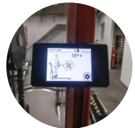
Intuitives Display zum Voreinstellen von Drehwinkeln und Geschwindigkeit
