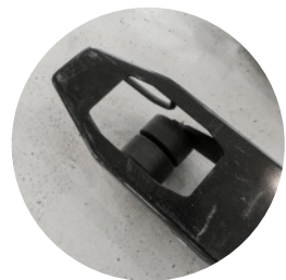
Doppelte Gabelrollen zum einfachen Wechsel der Richtung
