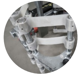
Sonder-entwickelte Greifer aus Polyurethan
